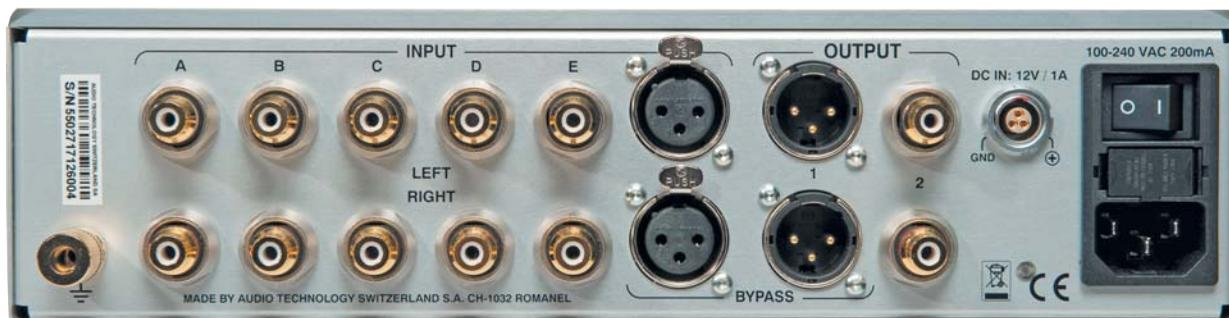
L'entrée A est réservée à l'option phono et l'entrée XLR travaille en by-pass direct avec la sortie XLR quand celle-ci est sélectionnée. La fiche Lemo, à droite, permet de raccorder un module d'alimentation externe Nagra ACPS II.
